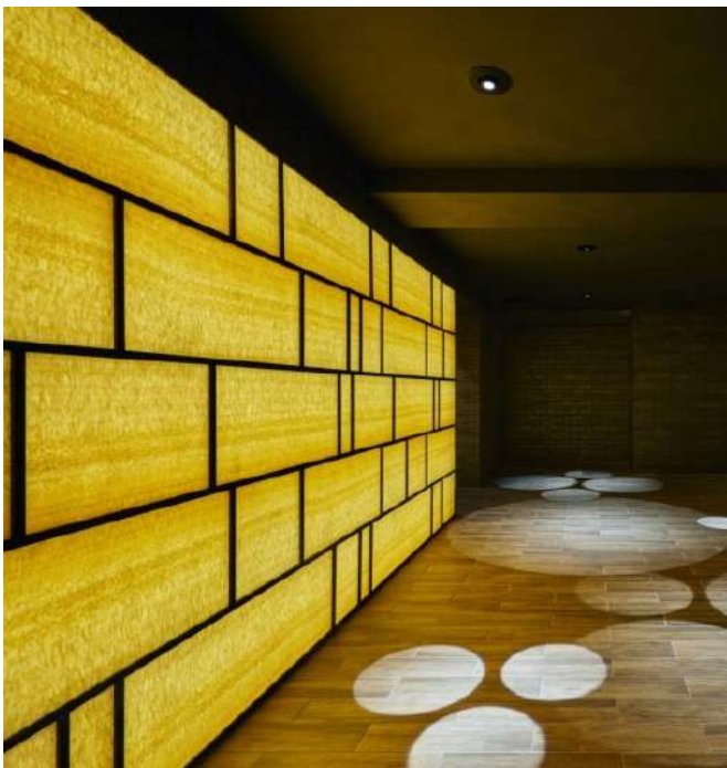
LSP-TW3W 3000K LED取付ピッチ150mm イエローオニキス+ABSハニカム
